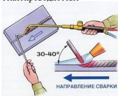
4. Сварку ведут справа налево, сварочное пламя направлено на еще не сваренные кромки металла, а присадочную проволоку перемещают впереди пламени. Для более равномерного прогрева кромок и лучшего перемешивания металла сварочной ванны производятся зигзагообразные движения наконечника и проволоки. Такая сварка обеспечивает более равномерную высоту и ширину шва в сварном соединении, наибольшую производительность и меньшую стоимость при сварке листов толщиной до 3 мм
